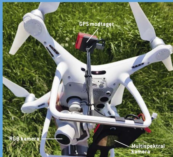
Drone udstyret med to forskellige kameraer og GPS
